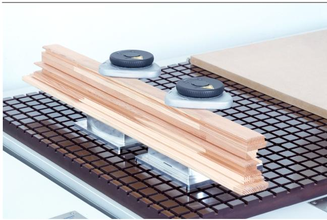
Mechanischer Spanner VCMC-R-QUICK beim Aufspannen von Rahmenteilen
